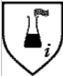
La norma EN374-3 riguarda la determinazione della resistenza dei materiali con cui sono fatti i guanti alla permeabilità rispetto a prodotti chimici che non siano gas e che siano potenzialmente pericolosi in caso di contatto continuo.
