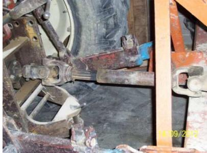
Figura 33. Assenza totale di protezione
